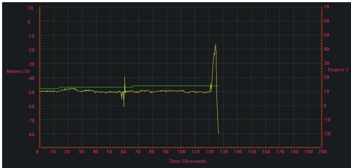
De los gráficos se desprende que los datos de temperatura se ajustan bastante (alrededor de los 10°C) y la altura alcanzada fue de 35 metros (cada división corresponde a una altura de 10 m). El dato de altura parte de -50 ya que en el montaje se encendió y apagó varias veces el altímetro, ocasionando la descalibración del sensor de presión.
