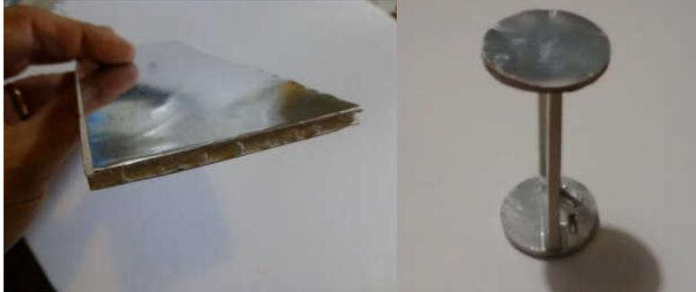
*Verificaciones:* sólo se midieron las dimensiones exteriores y se peso del conjunto (12 gramos), pero no se realizaron verificaciones mediante ensayos de integridad estructural.
